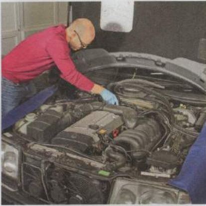
Der M-104-Sechszylinder im Mercedes 320 E zählt zu den typischen Kabel-Patienten jener Baujahre
