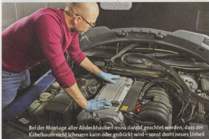
Das Einfädeln des Neuteils erfordert zwar etwas Geduld, doch lässt es sich komplett einbauen,...
