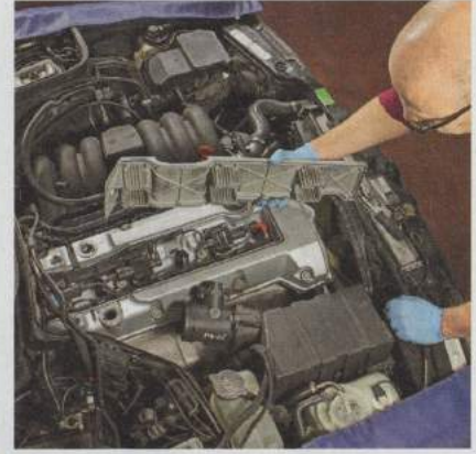
Der Kabelbaum ist zum Glück gut erreichbar; auch die Zündmodule müssen freigelegt werden
