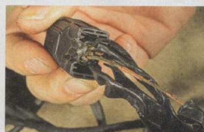
Einige Stecker gibt es im freien Handel nicht. Hier werden geprüfte Gebrauchtteile weiterverwendet
