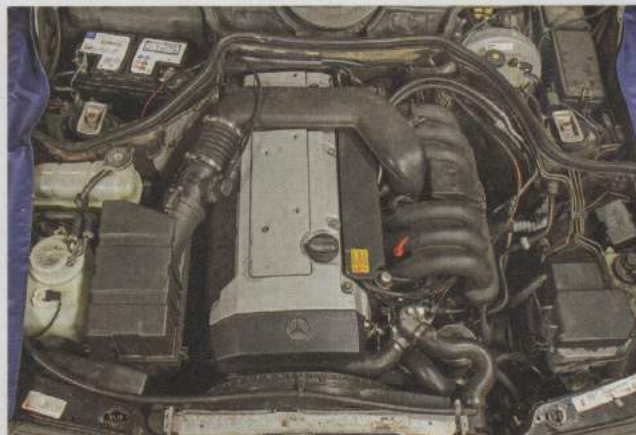
Erst wenn der Motor für den Probelauf bereit ist, wird die Batterie eingebaut. Das Triebwerk lief auf Schlüsseldreh; zuletzt wird der Fehlerspeicher gelöscht
