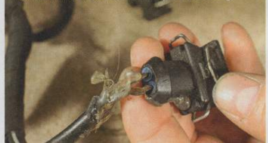
Blanke Anschlüsse, hilflose Reparaturversuche: Das, was man hier sieht, ist leider oft nur die Spitze des Eisbergs
