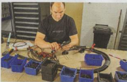
Kein bearbeiteter Kabelbaum verlässt die Werkstatt, ohne vorher durchgemessen zu werden
