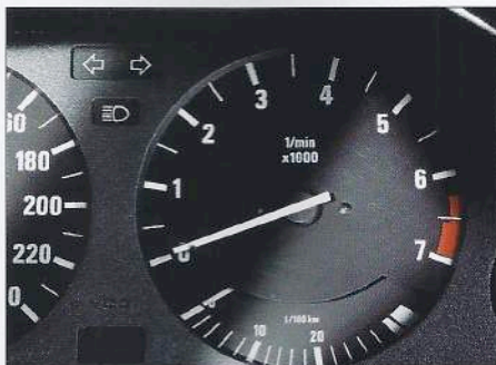
②⑤ Drehzahlmesser mit Energie-Control für den 316i. Motordrehzahl und momentaner Kraftstoffverbrauch auf einen Blick.
