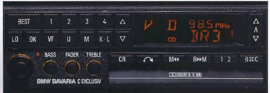
④ BMW Bavaria C Exclusiv. Vollstereo, U/M/K/L, Best-Station-Empfangsteil, Sendersuchlauf, Stationstasten, VF-Bereichsanzeige, Auto-Reverse, Dolby B und C, Bandsortenwahlschalter, Musiksuchlauf, geschwindigkeitsabhängige Lautstärkeregelung, 4fach-Endstufe mit integriertem Überblendregler, elektronische Diebstahlsicherung (Safety) mit LED, inkl. 4 Lautsprechern (nicht für 316i, 318i, 318is, 318i touring, 324d).
