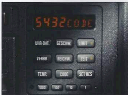
②④ Bordcomputer II, mit Fernbedienung vom Lenkrad aus. Er informiert Sie über Außentemperatur, Reichweiten, Durchschnittsverbrauch und sichert Ihr Fahrzeug mit einem frei programmierbaren Code.
