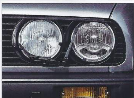
⑤② Scheinwerfer-Wisch-Waschanlage, sie garantiert auch bei Schnee- und Regenwetter saubere Scheinwerfergläser und damit stets ideales Licht.
