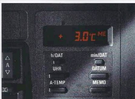
②⑥ Außentemperaturanzeige/Digitaluhr. Die Außentemperatur erscheint auf Knopfdruck oder automatisch, wenn die Temperatur unter 3°C absinkt. Ein Signalton warnt zusätzlich vor Glatteisgefahr.
